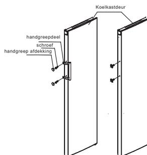
3. Bevestig het handvat met de schroeven in de plastic zak. En installeer de handvat afdekking zoals de bovenstaande figuur laat zien.
